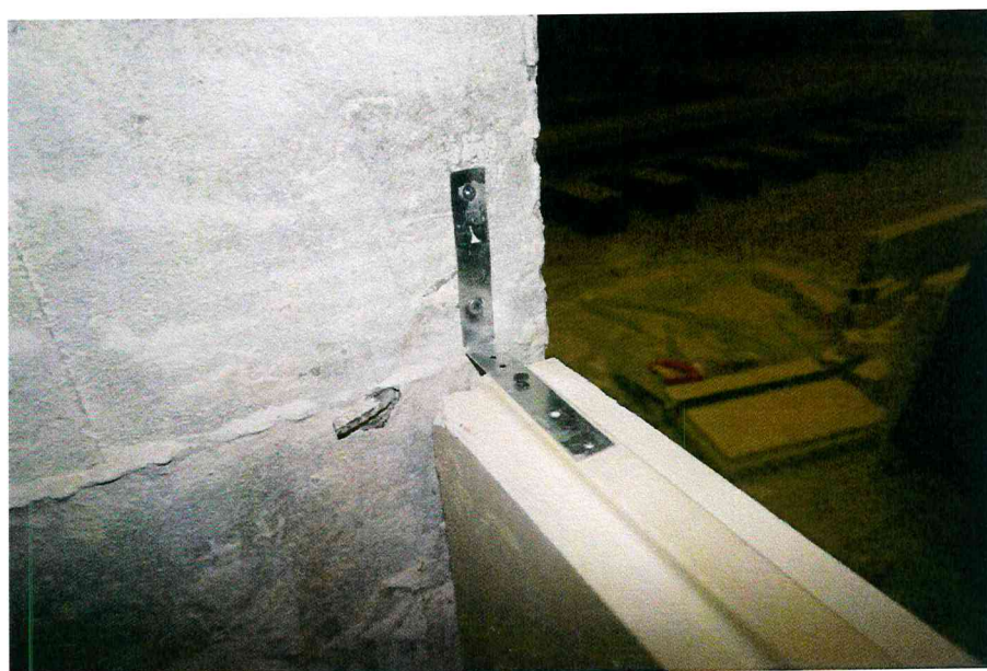
Рисунок 13 – Крепление перегородок и раме вибростенда
