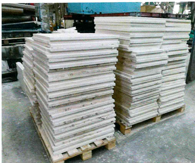
Рисунок 5 - Полнотелая ПГП толщиной 80мм
